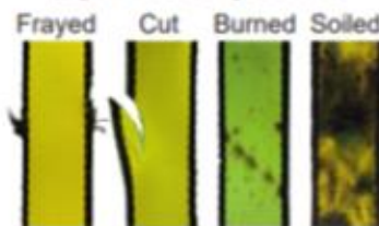
Fig. A: Webbing Defects
