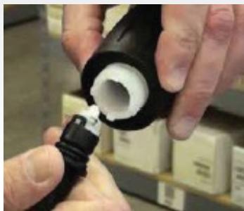
**Paso 8:** Tome el retenedor blanco y gírelo  $\frac{1}{4}$  en sentido contrario a las agujas del reloj para sacar las piezas de la válvula de retención. Saque el resorte y el cono. Revise la junta de anillo y reemplácela si está desgastada o rallada.
