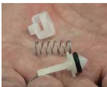
**Paso 10:** Para volver a ensamblarla, coloque el cono dentro de la válvula de retención.
