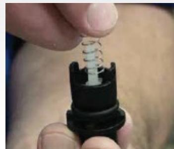
**Paso 12:** Vuelva a colocar el retenedor alineándolo y girándolo  $\frac{1}{4}$  en sentido de las agujas del reloj para fijarlo.
