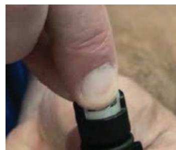
**Paso 14:** Vuelva a colocar la válvula de retención en el vástago.
