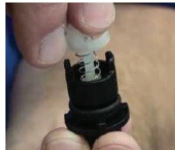
**Paso 13:** Tire la parte superior antes de volver a instalar la válvula de retención para asegurarse de que permanece unida.
