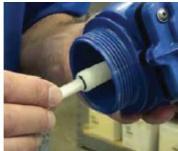
**Paso 17:** Pruebe la conexión empujando y tirando el émbolo. Debería hacer clic.
